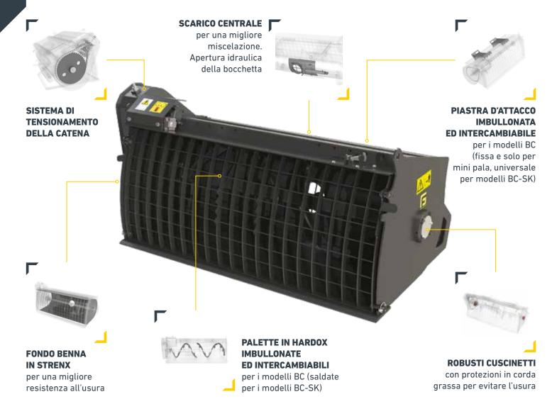
La benna miscelatrice è utilizzata per **produrre in maniera** rapida e semplice il calcestruzzo in cantiere. Il riempimento del materiale può avvenire utilizzandola come una classica benna, oppure caricando manualmente il materiale.
